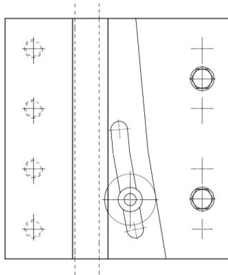
Die Fangvorrichtungen müssen paarweise oben oder unten auf den Fahrkorbrahmen montiert werden. Sie müssen in die Struktur eingelassen werden, andernfalls sollte ein Sperranschlag vorgesehen werden.
