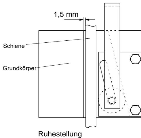
Die gerändelte Breite der Fangrolle muss von der Schienenauflagefläche voll überdeckt werden.
